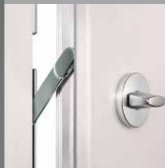
5-fach Verriegelung mit Türspaltsicherung (auf Wunsch) als Öffnungsbegrenzung. Wird außen über das Hauptschloss betätigt. Innen über einen Drehknopf zu öffnen.
