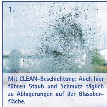
1. Mit CLEAN-Beschichtung: Auch hier führen Staub und Schmutz täglich zu Ablagerungen auf der Glasoberfläche.
